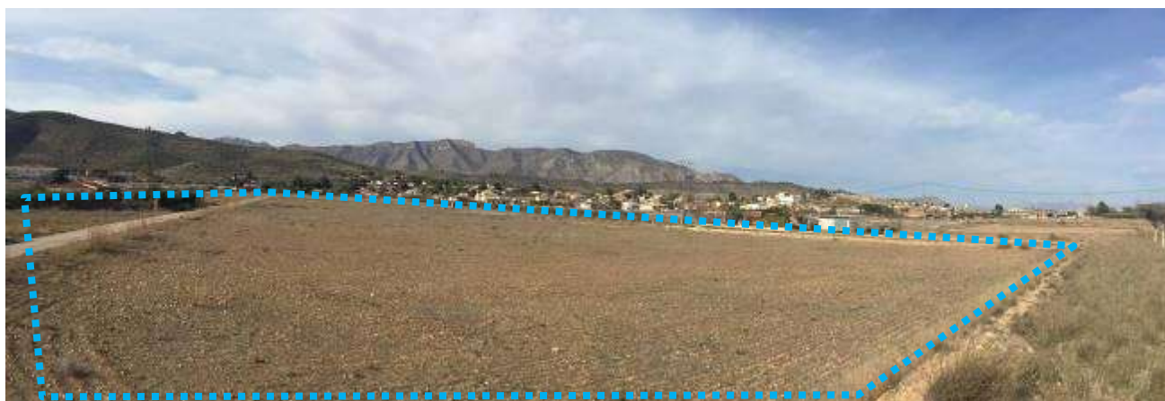
Aspecto de la zona central de la depresión tectónica de La Fondura (marcada en azul). Las tonalidades rojizas de los suelos muestran los materiales arcillosos impermeables. Al fondo se aprecian las Casas de Galiana, cuya elevación cierra la zona inundable por el este.
