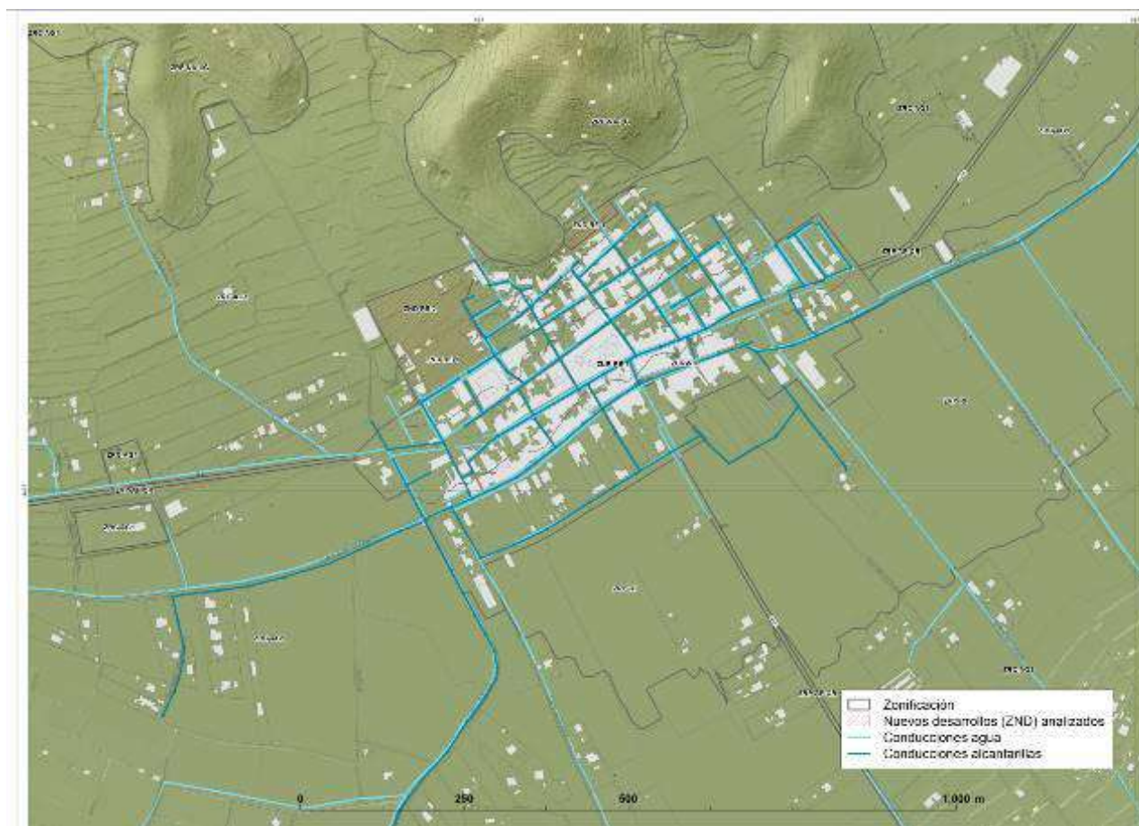
Figura 7: detalle de las conducciones incluidas en la modelización hidráulica IBER
